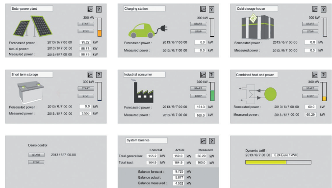
Darstellung der Anlagenübersicht im Überwachungs- und Steuerungssystem
